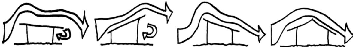
Ilustración 33 Distintos efectos del viento en función del tipo de cubierta (Elaboración propia del autor)
