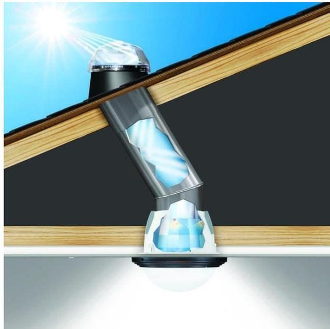
*Ilustración 41 Sección tubo solar (Ecoinventos. (30 de enero de 2022). Sistema de iluminación natural Solatube [Ilustración]. Ecoinventos. <https://ecoinventos.com/solatube-luz-natural/>)*
