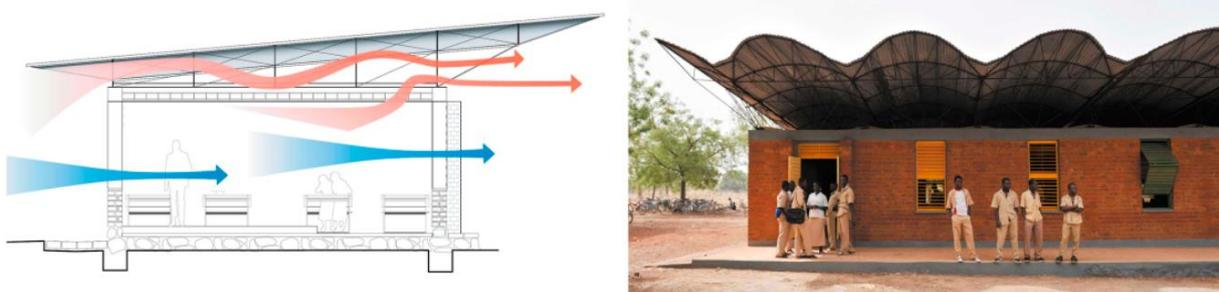
Ilustración 34 Ejemplo de uso de cubierta doble (Tectónica. (18 de agosto de 2022). Extensión de Escuela Secundaria en Dano, Burkina Faso, de Francis Kéré. Unas aberturas en el techo permiten la salida del aire caliente, buscando la ventilación natural del edificio a través de la cubierta. [Ilustración y Fotografía]. Tectónica. <https://tectonica.archi/articles/cubiertas-ventiladas/>)
