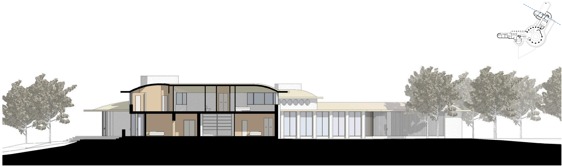
Fig 82. Casa Miller. Sección por Dormitorios Familiares. Nucleo de Noche. Dibujado a partir de los planos originales.
