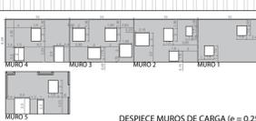
DESPIECE MUROS DE CARGA (e = 0,25 m)
