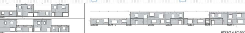
DESPIECE MUROS DE CARGA (e = 0,25 m)
