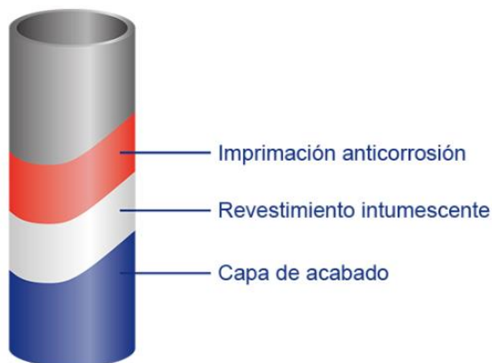
Fig. 8. Las distintas capas de la pintura intumescente, fabricante NULLIFIRE tipo SC902 (120 min).
