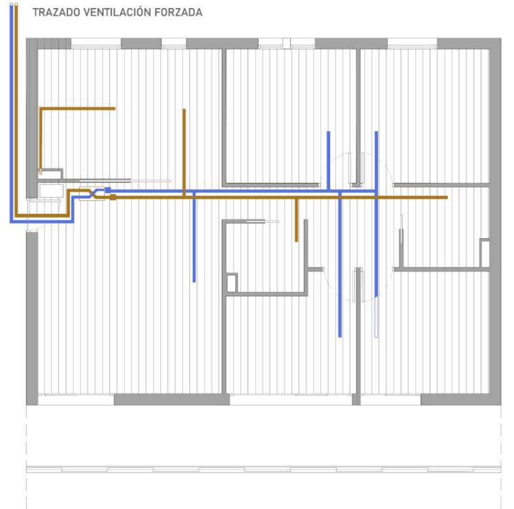
TRAZADO VENTILACIÓN FORZADA
