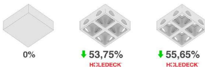
Al reducirse el volumen construido a acondicionar se reduce el consumo energético en climatización. Se pueden reconfigurar las instalaciones y la planta, sin demoliciones ni actuaciones importantes, aumentando la vida útil del edificio.
