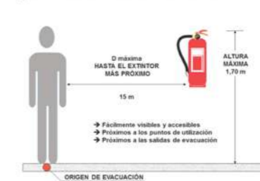
Esquema de colocación de los extintores
