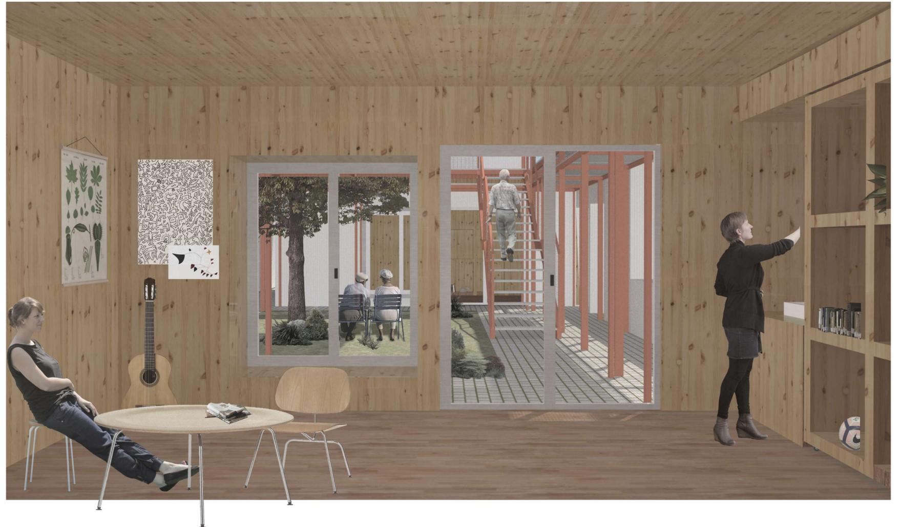
1. Zona común intercaladas entre los patios a modo de unión. Posibilidad de dividir el espacio en dos mediante dos estanterías móviles de CLT.
