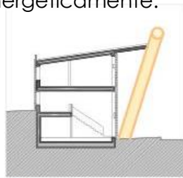
1. Alero en la fachada sur que controlan la incidencia solar, permitiendo la entrada de luz en invierno y reduciendo la entrada en verano.
