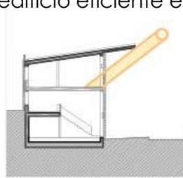
1. Alero en la fachada sur que controlan la incidencia solar, permitiendo la entrada de luz en invierno y reduciendo la entrada en verano.
