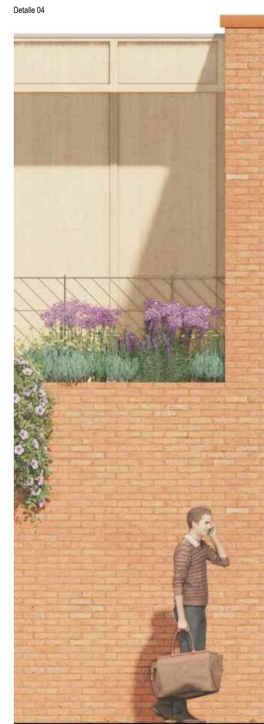
Detalle de la envolvente. Las fachadas a vía pública se proyectan con sistema de aislamiento por la cara exterior del muro portante de termoarcilla y medio pie de ladrillo caravista. Las piezas cerámicas dan la imagen exterior del conjunto. Se proponen ladrillos de la casa PETERSEN TEGEL modelo D33 de color rojo recibos con mortero rojo y tendeles matados en su línea superior.
