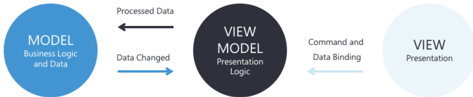
Figura 5.38: Funcionamiento del patrón arquitectónico MVVM. Tomado de [10]
