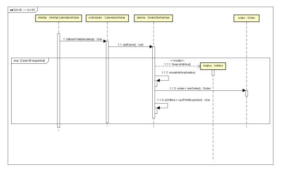
Figura 6.11: Diagrama de secuencia correspondiente al caso de uso CU-05
