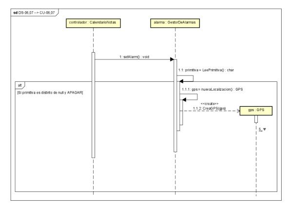
Figura 6.12: Diagrama de secuencia correspondiente al caso de uso CU-06 y CU-07
