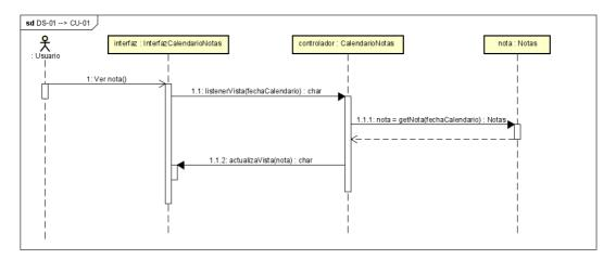
Figura 6.7: Diagrama de secuencia correspondiente al caso de uso CU-01
