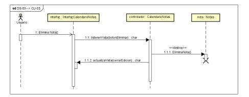
Figura 6.9: Diagrama de secuencia correspondiente al caso de uso CU-03
