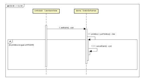
Figura 6.13: Diagrama de secuencia correspondiente al caso de uso CU-08
