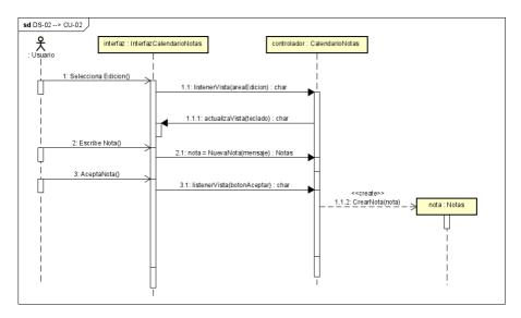
Figura 6.8: Diagrama de secuencia correspondiente al caso de uso CU-02
