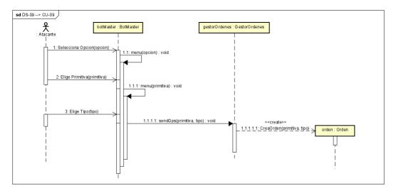
Figura 6.14: Diagrama de secuencia correspondiente al caso de uso CU-09
