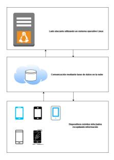
Figura 6.2: Diagrama de la arquitectura de proyecto de alto nivel
