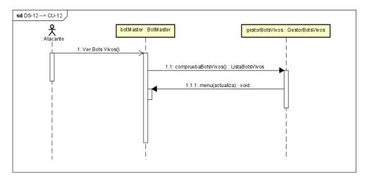
Figura 6.17: Diagrama de secuencia correspondiente al caso de uso CU-12
