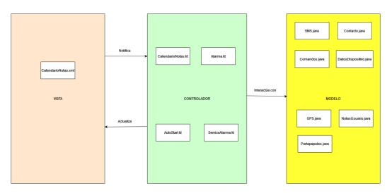
Figura 6.1: Patrón de diseño MVC aplicado al Bot
