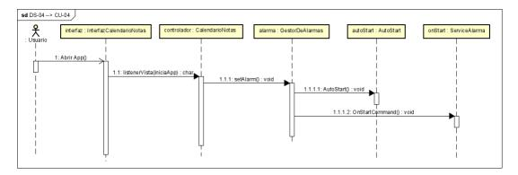
Figura 6.10: Diagrama de secuencia correspondiente al caso de uso CU-04
