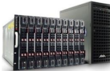
Figura 3c: Servidor tipo Balde.
