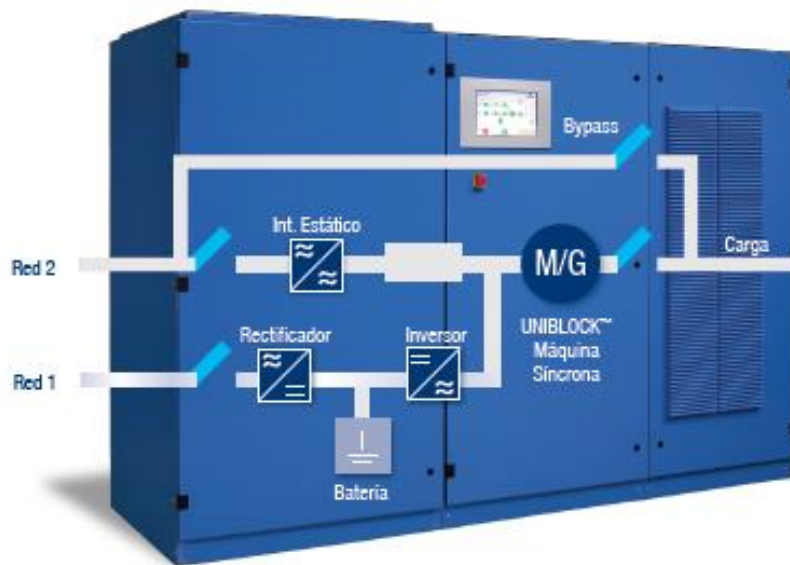
Figura 26: Configuración interna de una SAI estática modular.
