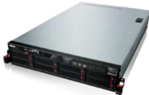
Figura 3b: Servidor tipo Rack.
