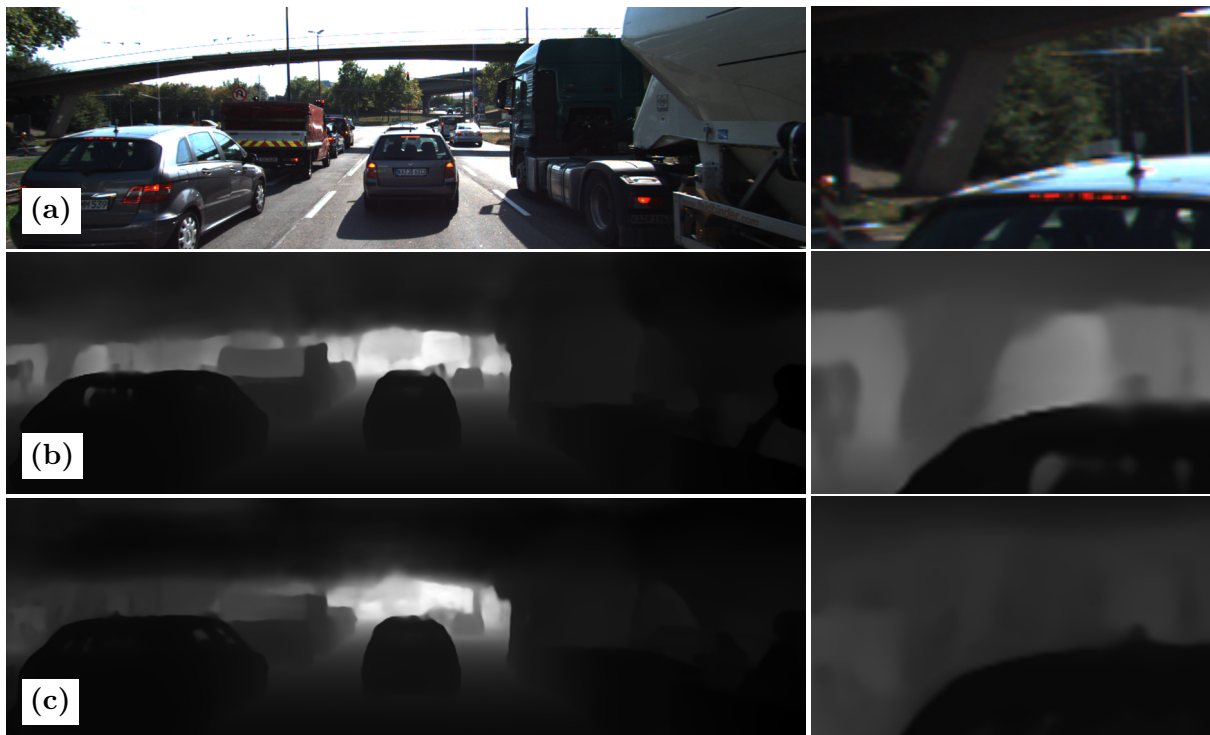
Figura 5.15: Resultados en función del backbone empleado. (a) Entrada del modelo y detalle. (b) Salida del modelo equivalente a DPT con el tamaño de entrada reducido (ResNet50). (c) Salida del modelo equivalente a DPT con el tamaño de entrada reducido y EfficientNet-B0 como backbone .
