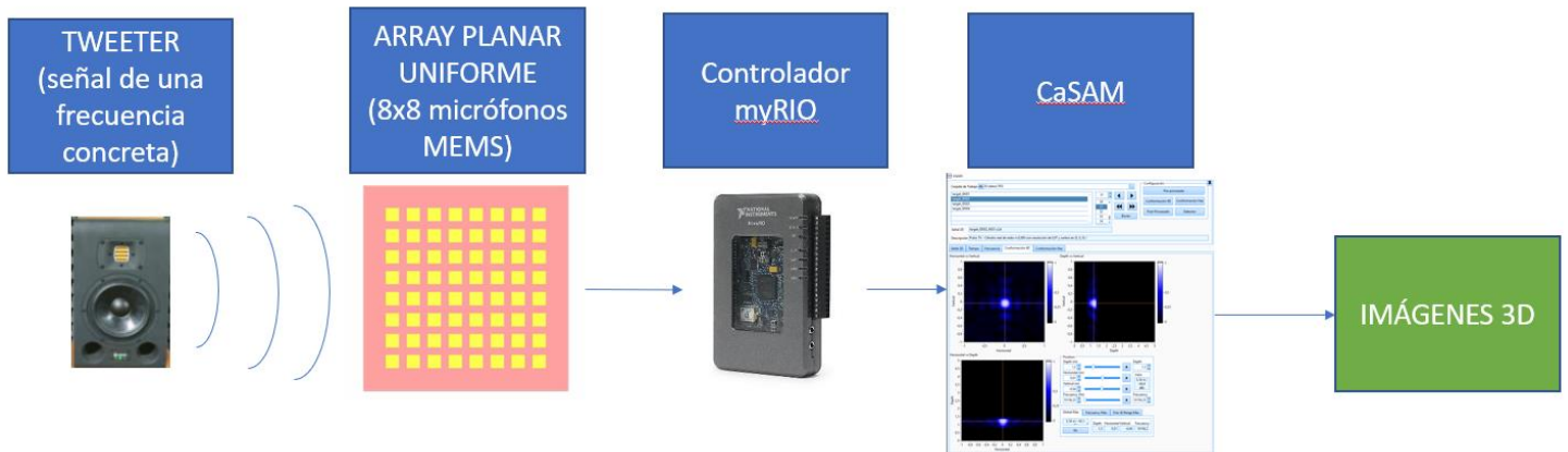
Figura 10: Componentes del sistema de adquisición acústico basado en MEMS (SAM).
