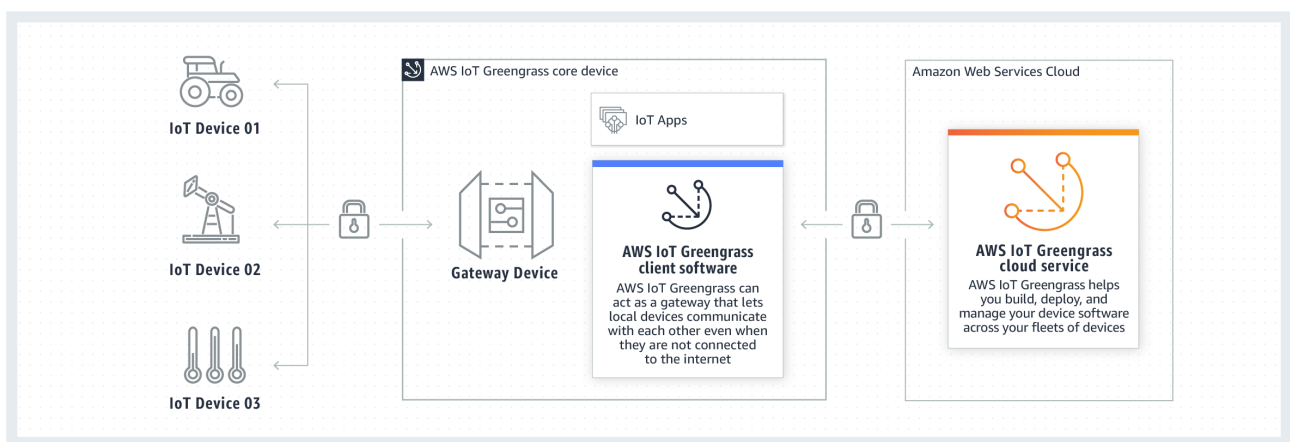
Figura 7.4: Ejemplo de una solución IoT mediante AWS IoT Greengrass, tomado de [Ama20]
