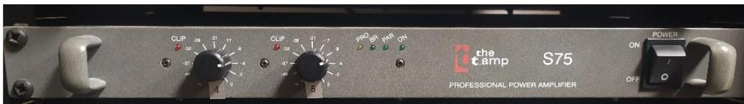
Figura 18: Amplificador externo
