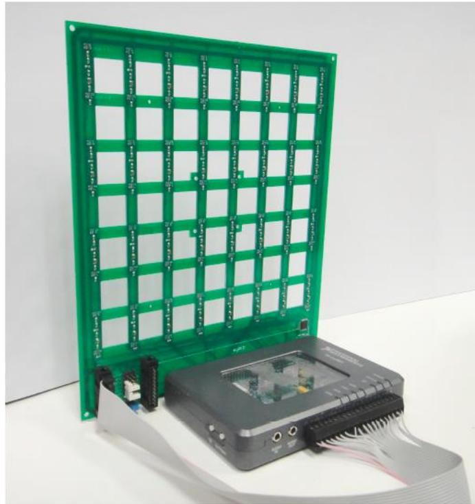
*Figura 19 myRIO conectada al array acústico MEMS [30]*
