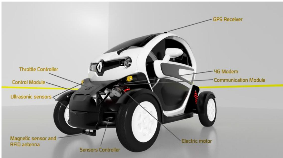
Figura 2. Modificaciones y adiciones instaladas en los vehículos Twizy [1].
