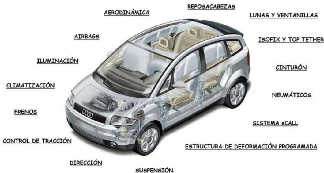
Figura 24. Sistemas de seguridad en un vehículo [82].
