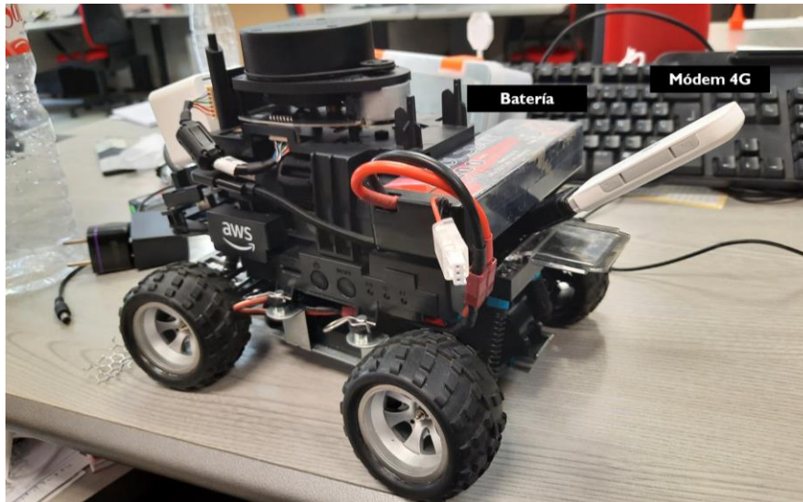
Figura 29. Nueva batería y módem 4G instalado.
