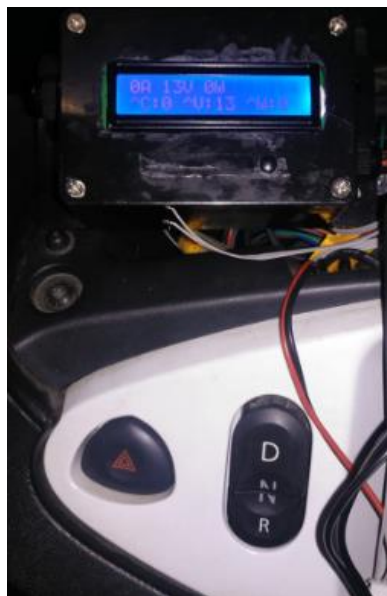
Figura 56. Multímetro integrado en el vehículo.
