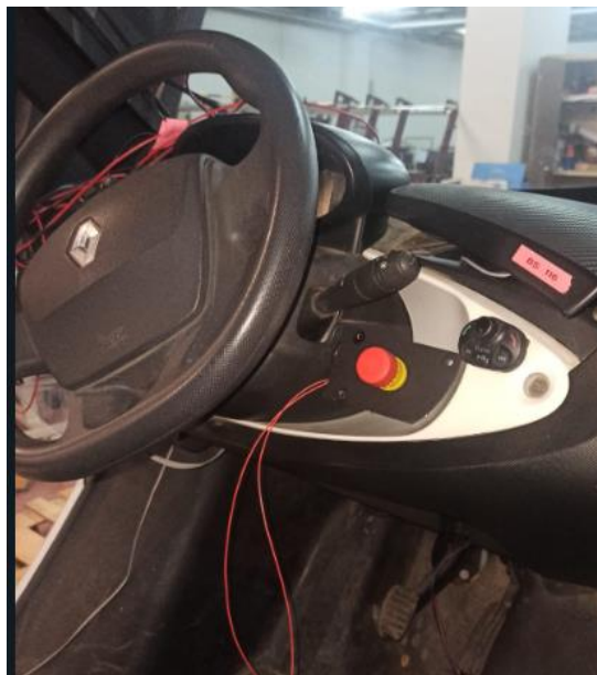
Figura 47. Resultado final seta integrada en el vehículo.
