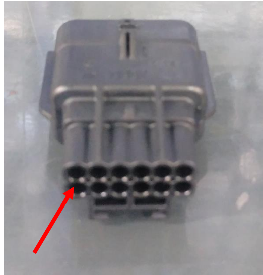
Figura 41. Conector hembra Yazaki, pin conectado a la seta de seguridad.
