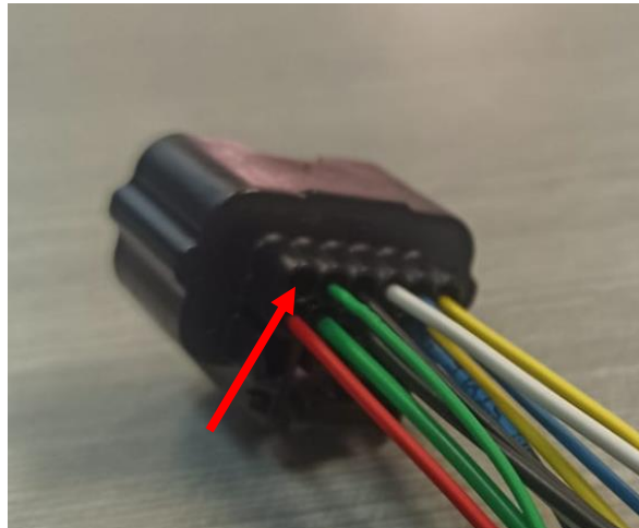
Figura 42. Conector macho Yazaki, pin conectado a la seta de seguridad.
