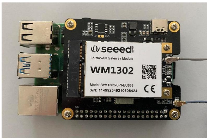
Fig. 53 Módulo montado en la raspberry pi.
