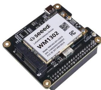
*Fig. 23 Adaptador para el módulo WM1302 [32]*
