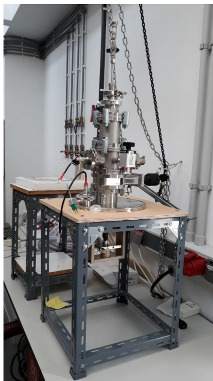
Figura 4 – 4. Foto de uno de los inyectores de muestra del espectrómetro de microondas
