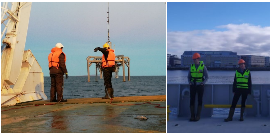
Figura 14. Fotografía del muestreador “multi-corer” empleado en 2021 para la toma de sedimentos (izquierda). Y fotografía mía en el barco junto a un compañero de trabajo (derecha).
