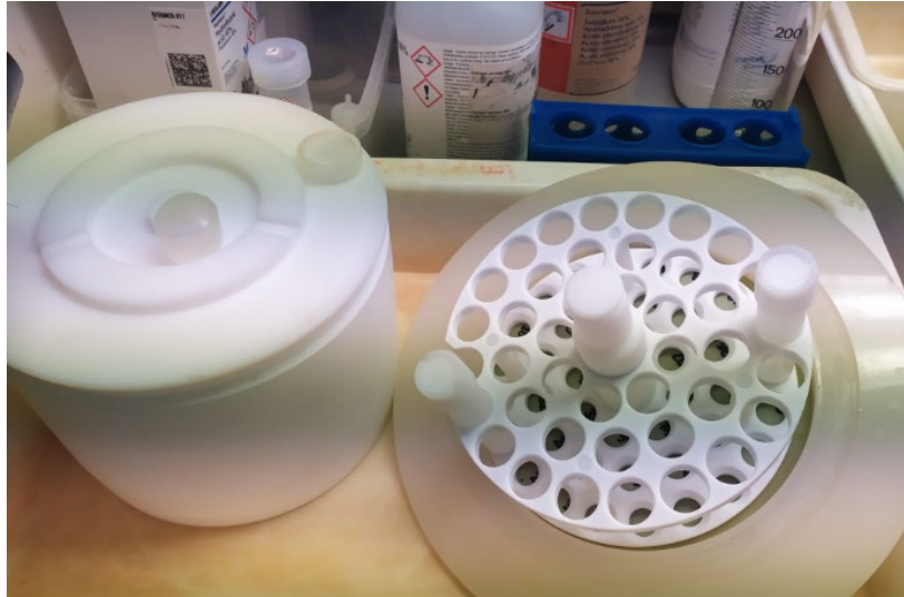
Figura 28. Fotografía de la bandeja donde se colocan los tubos de UC para su digestión.
