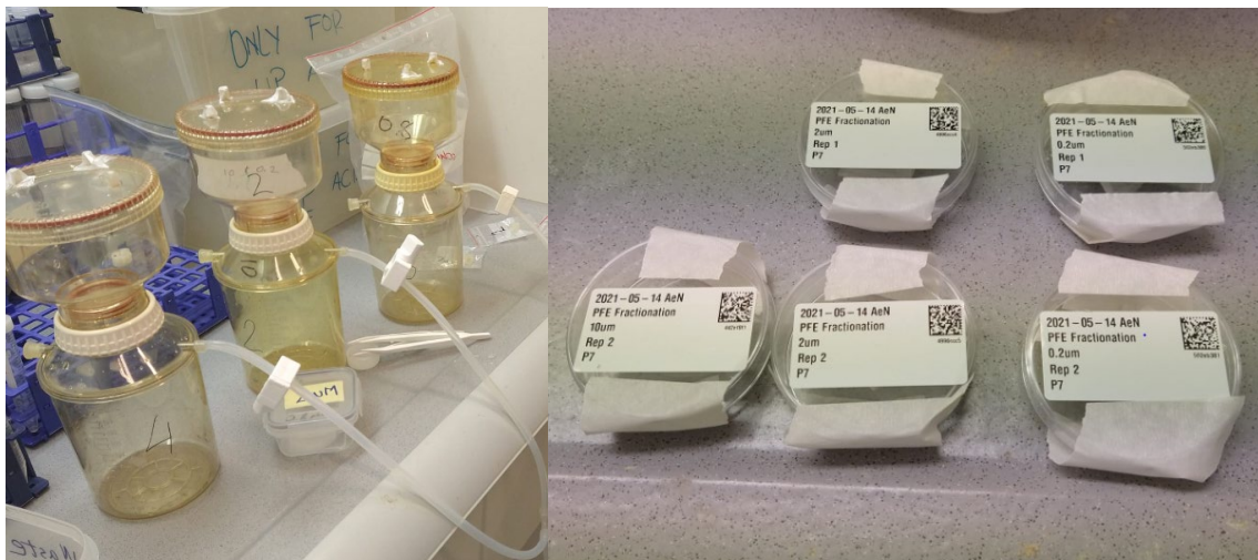
Figura 12. Fotografías de los sistemas de filtrado para obtener las muestras de material particulado en filtros de 2 \mu\text{m} de tamaño de poro y las placas Petri etiquetadas con sus correspondientes filtros.
