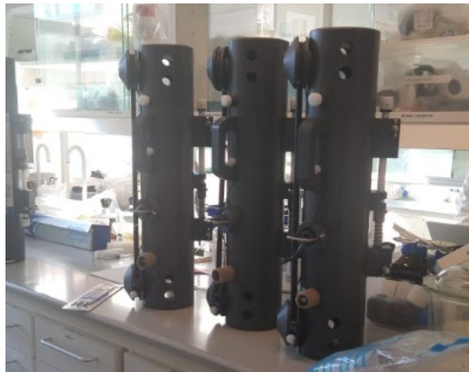
Figura 11. Fotografía de las botellas GO-FLO de 5 litros utilizadas para la toma de muestras de columna de agua.
