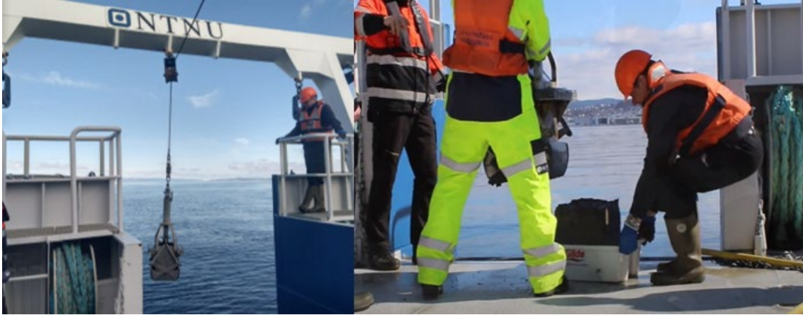
Figura 13. Fotografías donde se visualiza la técnica “box corer” empleada en el muestreo de sedimentos
