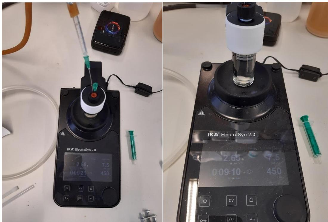
***Esquema 24: Dispositivo experimental de las reacciones de oxidación electroquímica***
