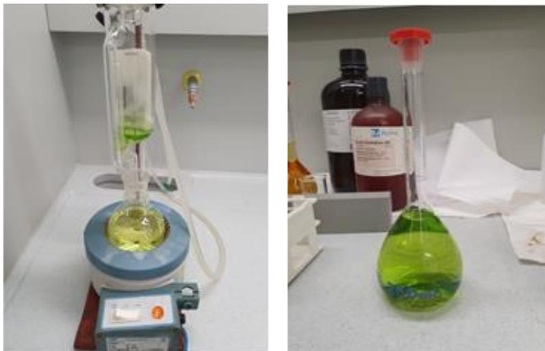
**Figura 22:** Aspecto de la extracción Soxhlet del cogollo y disolución final de 50 mL
