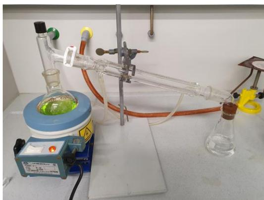
**Figura 23:** Proceso de destilación del etanol a partir del extracto de Soxhlet
