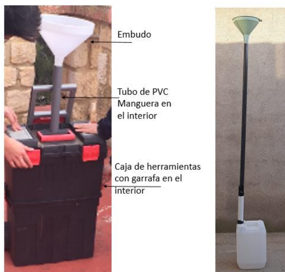
Figura 7. Montaje del dispositivo captador de partículas. (Imagen izquierda Fuente: Proyecto el aire que respiramos, Imagen derecha Fuente: Elaboración propia).
