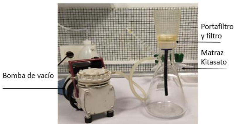
Figura 9. Montaje dispositivo de filtración de las muestras (Fuente: Elaboración propia).
