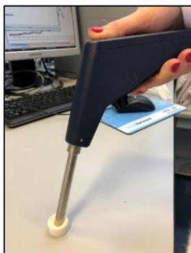
Figura 17. Sonda láser de fibra óptica del equipo NIRS
