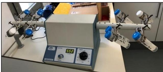
Figura 15. Agitador vibrador oscilante Vibromatic P Selecta
