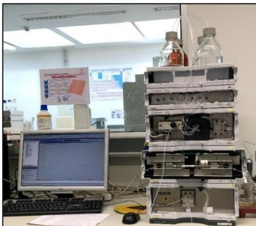
Figura 12. Equipo de HPLC/UV-Visible utilizado en este trabajo
