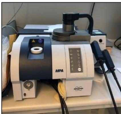
Figura 16. Equipo NIRS utilizado en este trabajo
