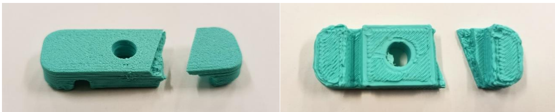
Img 200: Rotura por fallo de altura
