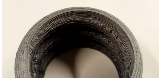
Img 204: Detalle de voladizo
