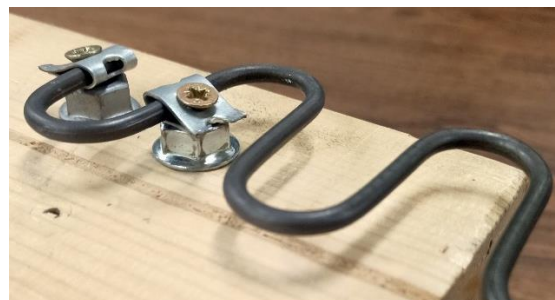
Img 142: Bridas metálicas
