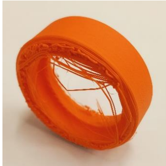
Img 206: Fallo de relleno
