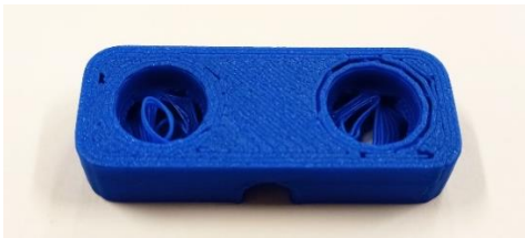
Img 208: Fallo de voladizo en orificios avellanados
