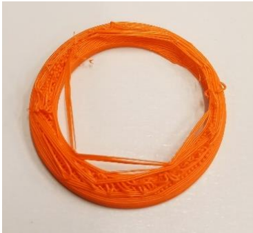
Img 205: Fallo de voladizo
