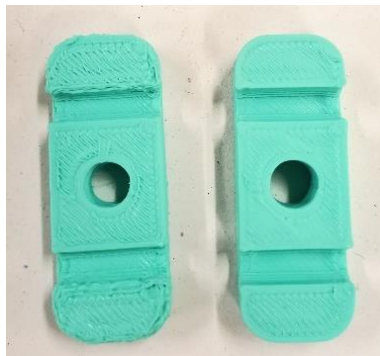
Img 203: Diferencia de acabados
