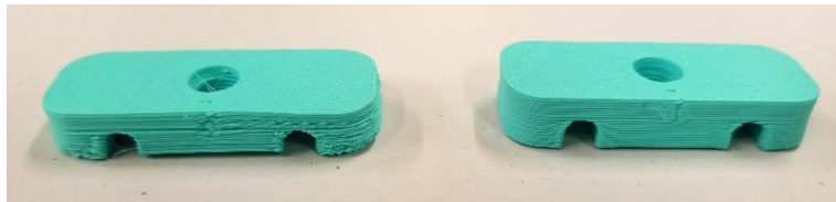
Img 199: Fallo en altura
