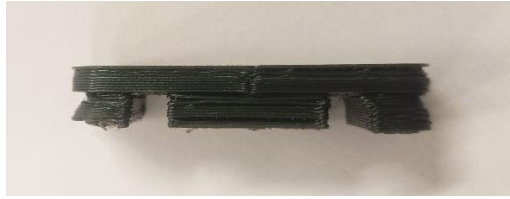
Img 192: Fallo por cracking
