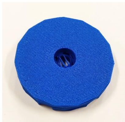
Img 210: Fallo por poligonalización
