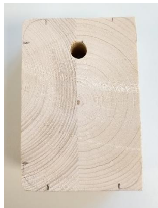
Img 39: Taladrado del apoyo
