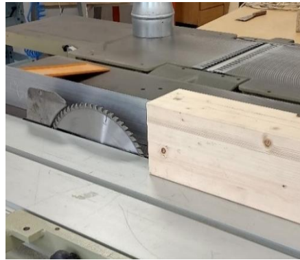
Img 37: Corte en la sierra de mesa
