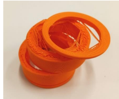
Img 207: Pieza con múltiples fallos
