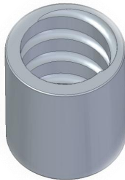
Img 25: Casquillo para el muelle helicoidal
