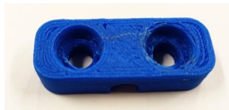
Img 209: Intento de solución lijando
