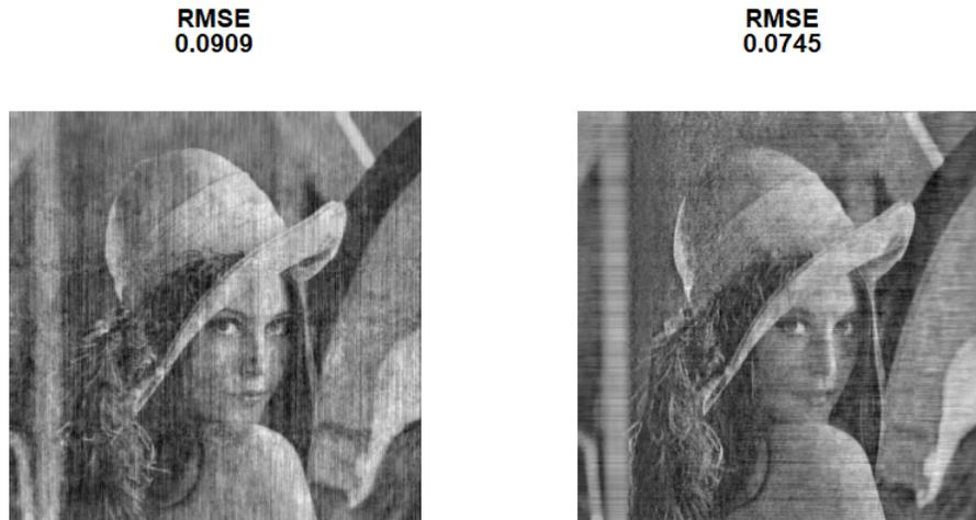
Figura 7.2: Compressed sensing por columnas y por filas tomando la dimensión de las proyecciones un 35 % de la original.
