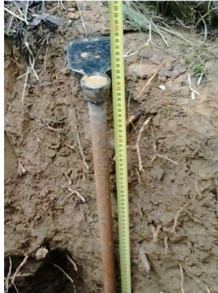
Figura 5.20. Determinación de la profundidad de sedimentación en un dissipador.
