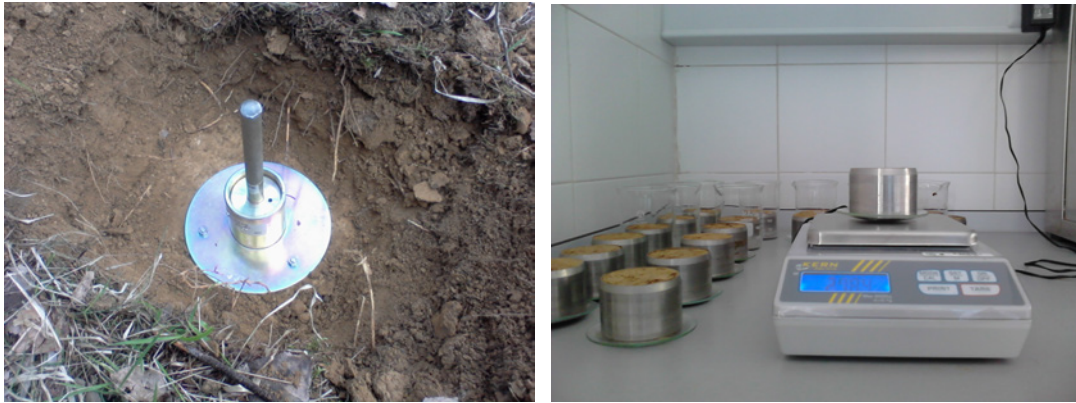
Figura 5.22. Determinación de densidad aparente mediante el método del cilindro. Toma de muestras en campo (derecha) y determinaciones en laboratorio (izquierda).
