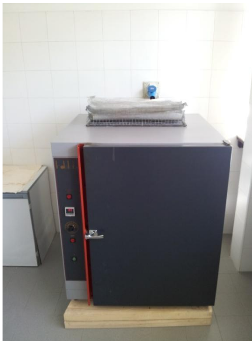
Figura 4.5. Estufa empleada para el secado de las probetas en laboratorio.
