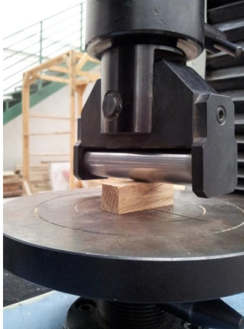
Figura 4.9. Cabezal para ensayos de 2 KN de fuerza y y 2 mm. de carrera.
