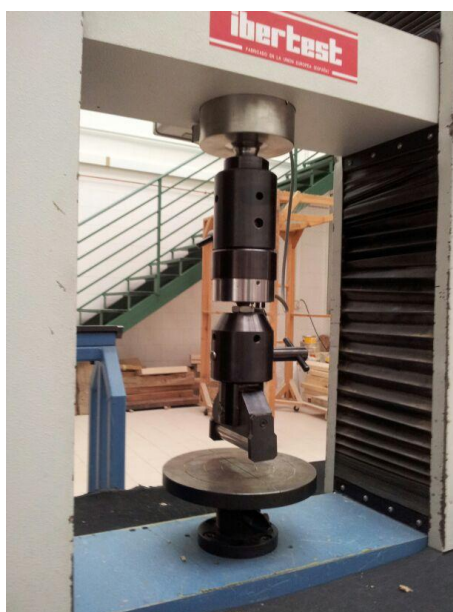
Figura 4.7. Máquina de ensayos universales IBERTEST mod. ELIB-1000W.
