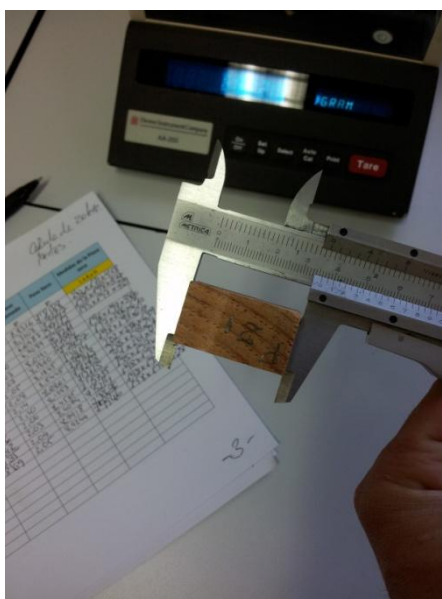
Figura 4.11. Detalle de medición en longitud de una de las probetas.
