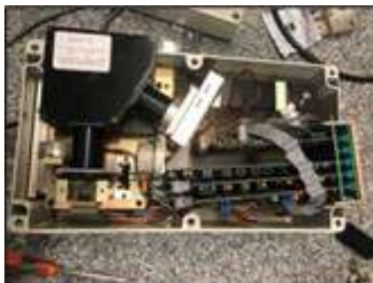
Figura 3: Estructura interna real del espectroradiómetro LI-COR
