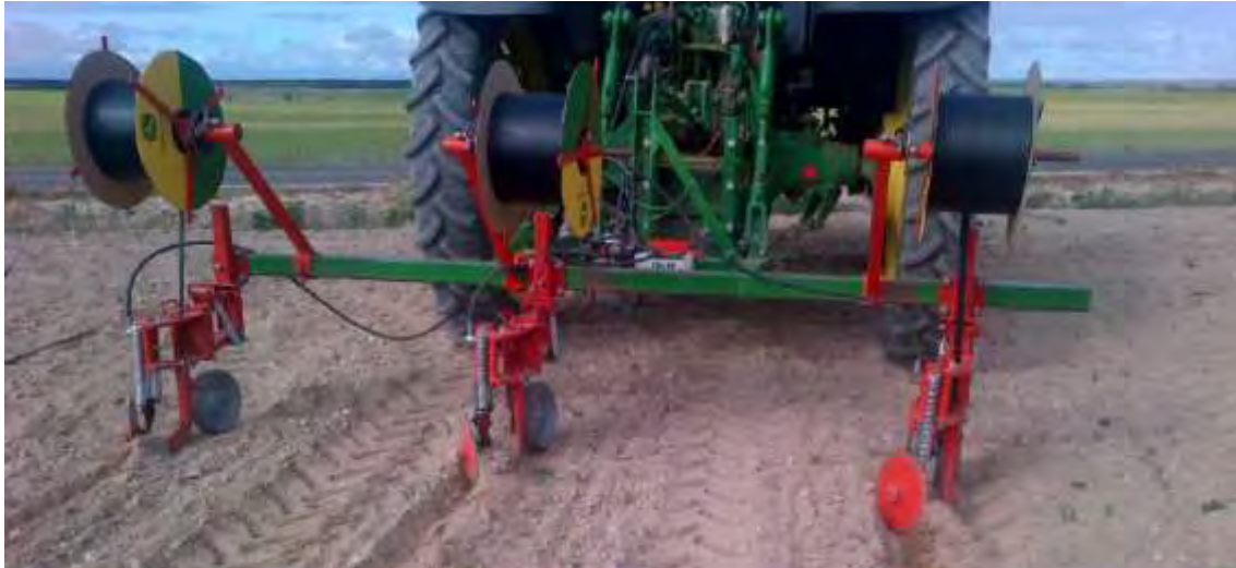
Figura 5.5. Máquina preparada para extender cinta de goteo.
