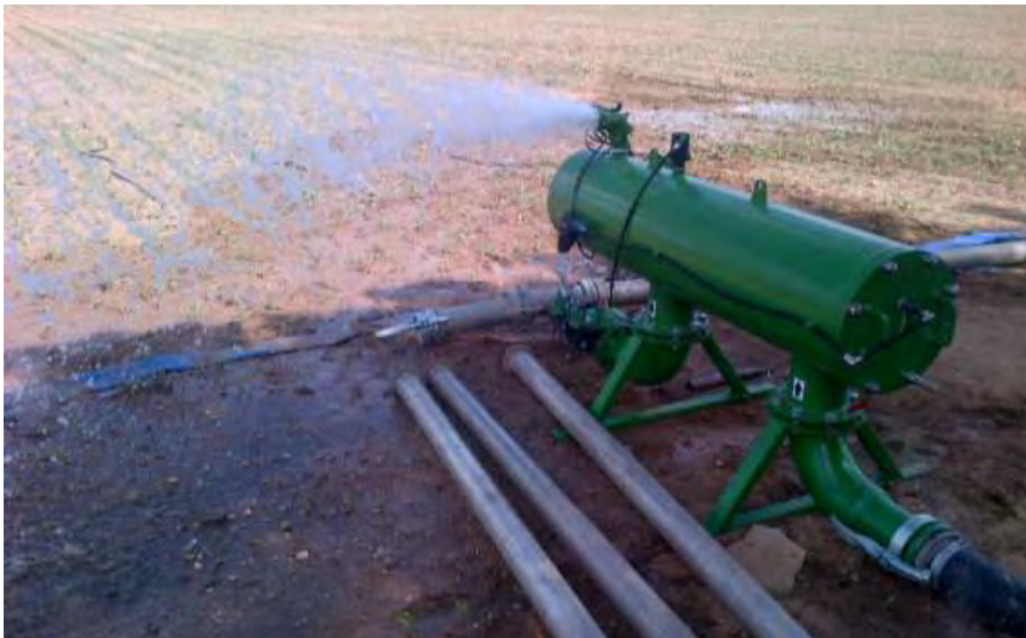
Figura 5.6. Accionamiento de limpieza de un filtro autolimpiante necesario para el riego localizado en zonas de agua canalizada.
