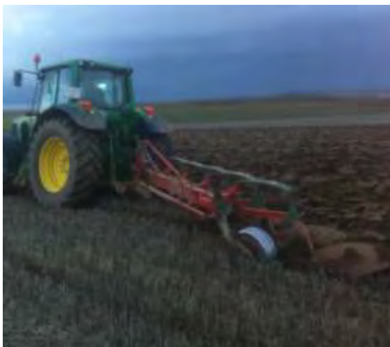
Figura III.1. Labor primaria con arado de vertedera.
