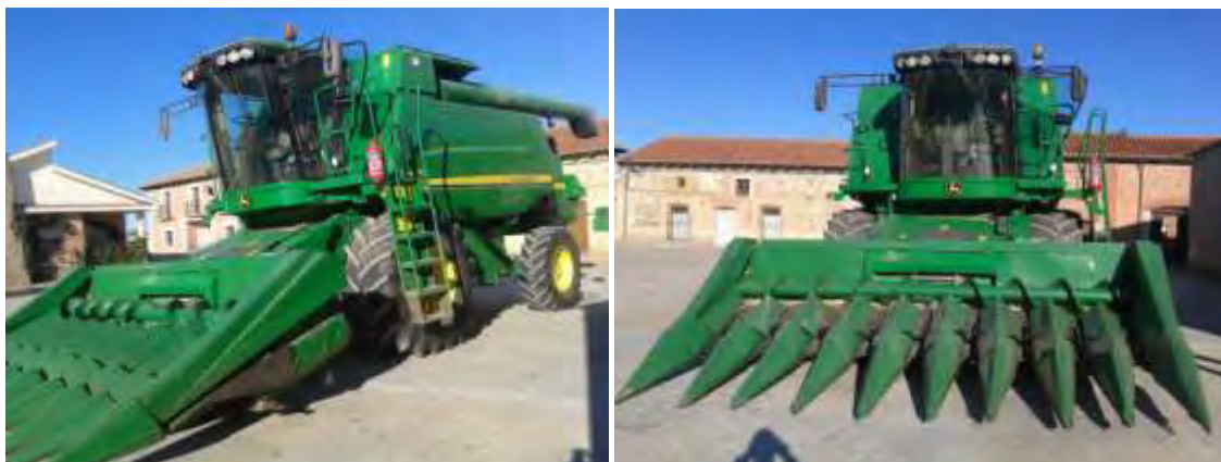
Figura III.5. Cosechadora de cereal con corte específico para maíz.
