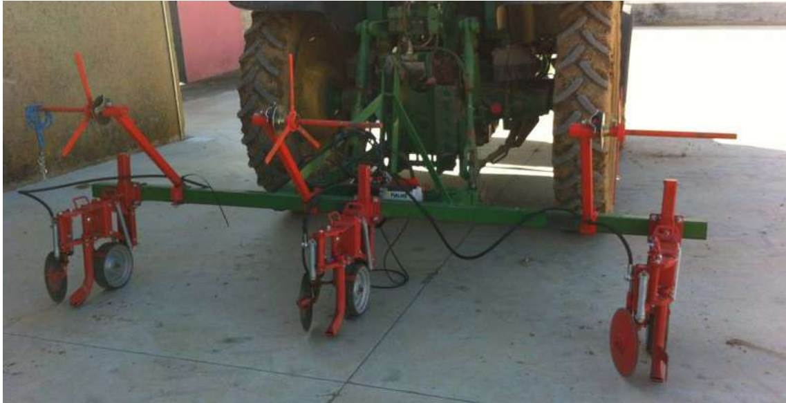
Figura II. 23. Máquina para extender cinta de goteo.
