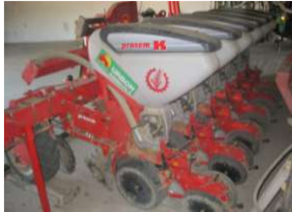
Figura III.3. Sembradora neumática de precisión.
