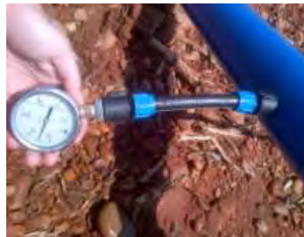
Figura II.18. Presión de los laterales entre 0.65 y 0.55 bar.
