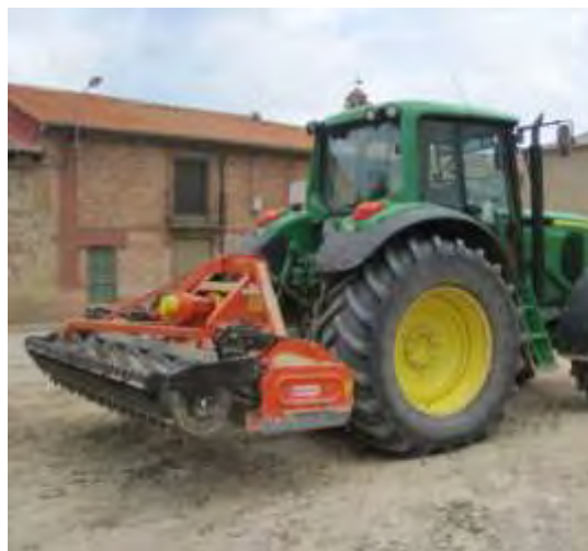
Figura III.2. Labor secundaria con grada rotativa.
