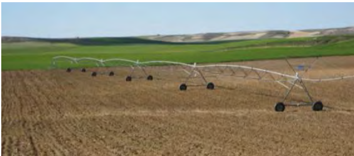
Figura II.13. Instalación de pívot central en parcela preparada para maíz.
