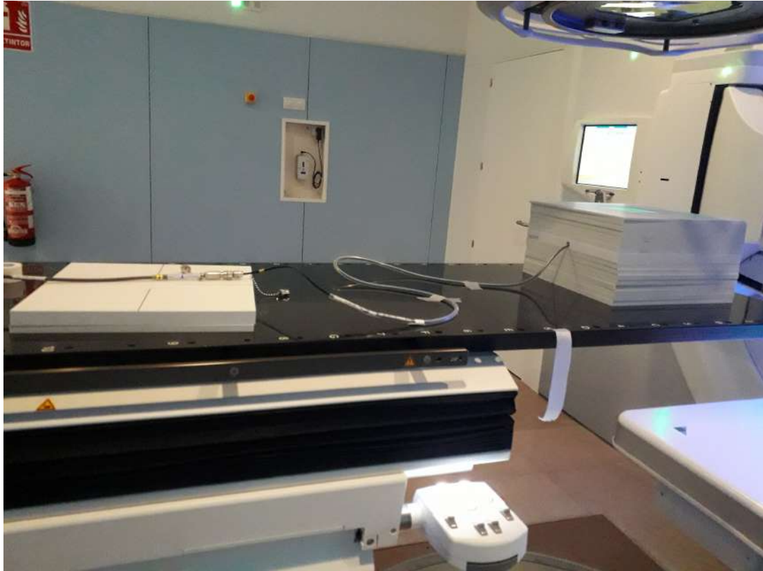
Fig. 4.15: Colocación de la cámara de ionización
