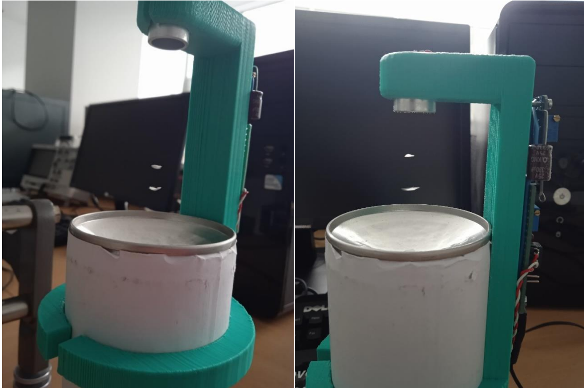
Fig. 15 Visualización de la levitación acústica.
