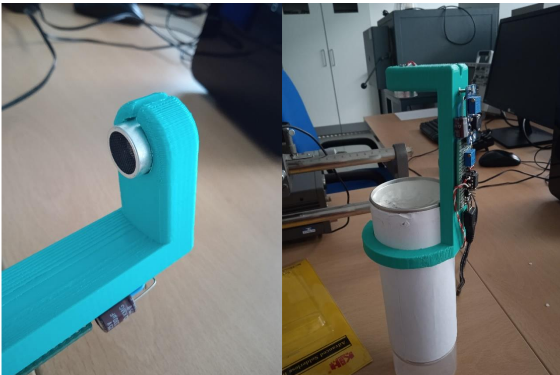
Fig. 14 (Izquierda) Transductor. (Derecha) Levitador que ya tenemos en el laboratorio.
