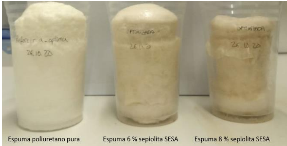
Figura 20: Espumas fabricadas en donde se observa la diferencia de color debido a la cantidad de sepiolita.
