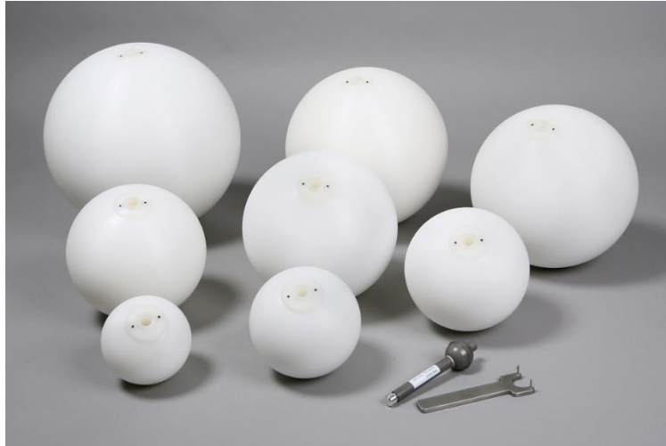
Figura 2. Esferas moderadoras de diferentes tamaños y detector proporcional a ^3\text{He} .
