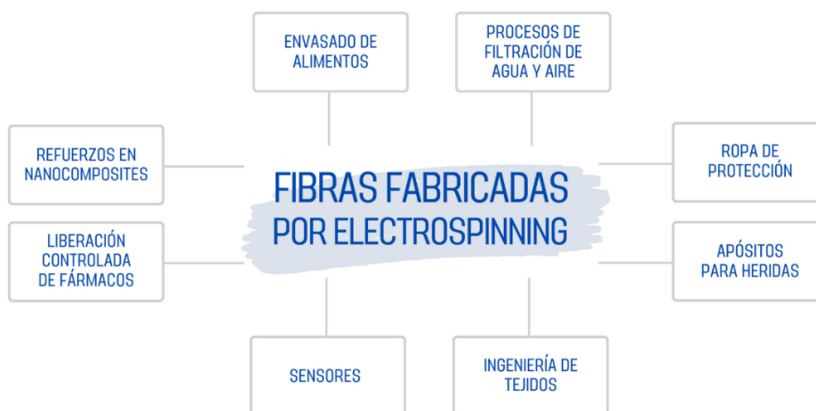
Figura 1: Esquema de las aplicaciones de las fibras poliméricas fabricadas por electrospinning.
