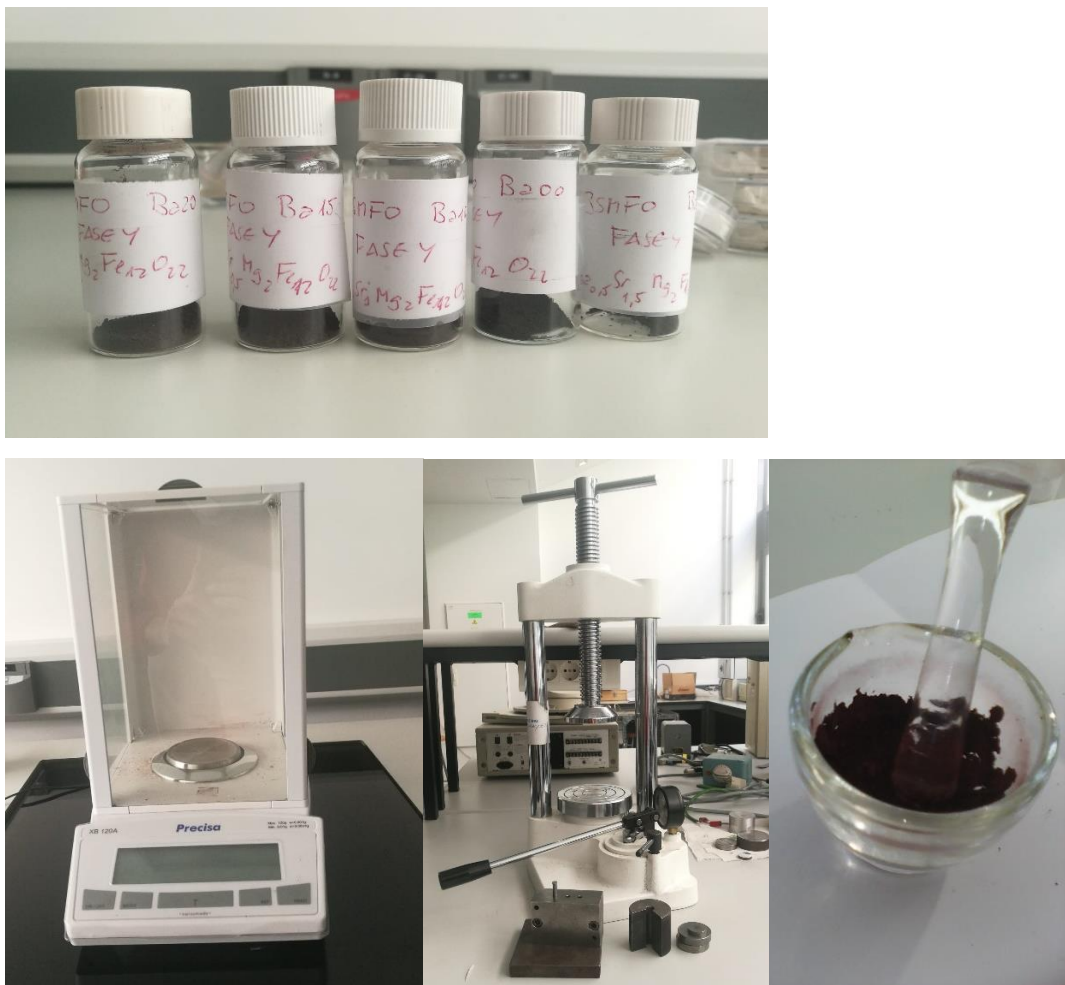
Figura 15. Muestras en polvo. Material empleado en la fabricación de ferritas. Balanza de precisión, troquel, mortero.
