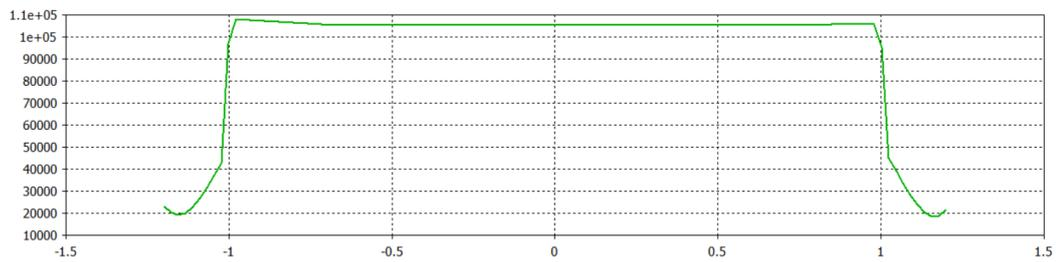
**Figura 2.16:** Campo eléctrico a lo largo del eje horizontal
