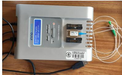
Figura 10: Láser montado en el Driver.
