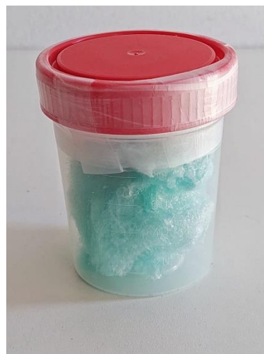
Ilustración 18: Aspecto del HRGD6 tras la modificación, con una tonalidad azulada a causa de la adición de Cy5.
