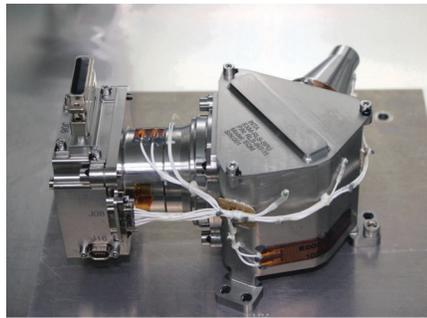
Figura 2: Espectrómetro (SPU) del instrumento RLS.
