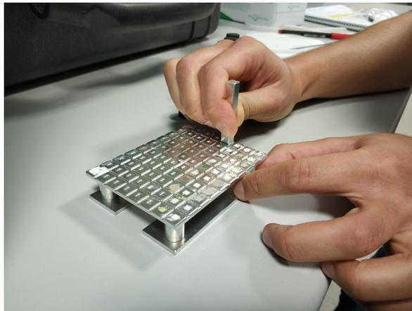
Figura 31: Platina con muestras de entrenamiento y verificación. El aplanado de la muestra facilita el enfoque automático.
