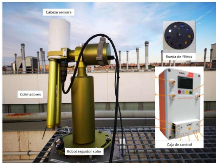
**Figura 2.2:** Esquema de cada uno de los elementos que componen el CIMEL CE318. En la imagen se puede ver en la parte izquierda la cabeza sensora montada en el robot seguidor. En la parte derecha se puede ver la rueda de filtros que está instalada en la cabeza y la caja de control del fotómetro (González, 2021).
