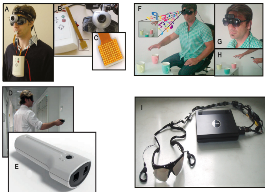
FIGURA 3. Dispositivos de sustitución sensorial (SSD). Ejemplos de la configuración experimental para varios dispositivos de sustitución sensorial diferentes. (A–C) La unidad de visualización de la lengua (TDU). (A) La cámara montada en un par de anteojos con los ojos vendados. (B) La configuración completa con cámara, caja convertidora de imágenes y cuadrícula de lengua. La caja, que se lleva en el pecho, controla la intensidad de la estimulación electrotáctil. (C) La rejilla de la lengua. Aplicado en la lengua, proporciona una sensación de hormigueo a través de los electrodos. (D) Un participante que sostiene el EyeCane que emite vibraciones y sonidos para indicar la distancia a un objeto. (E) Los sensores del EyeCane y del dispositivo. (F) La configuración experimental de EyeMusic con auriculares y cámara. (G) La cámara montada en la cabeza del EyeMusic. (H) EyeMusic convierte los colores en diferentes sonidos, lo que permite reconocer la manzana roja entre las verdes. (I) aparato de voz. Convierte imágenes visuales en paisajes sonoros (Meijer, 1992). 8
