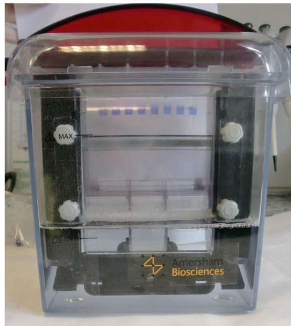
**Figura Me11. Detalle de cubeta electroforética al inicio de conectar los cables de la cubeta a la fuente de alimentación.**
