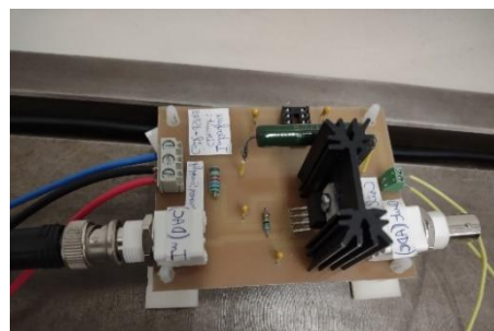
Figure 10: Carte de puissance amplificatrice du shunt (à droite) et son alimentation symétrique (à gauche)
