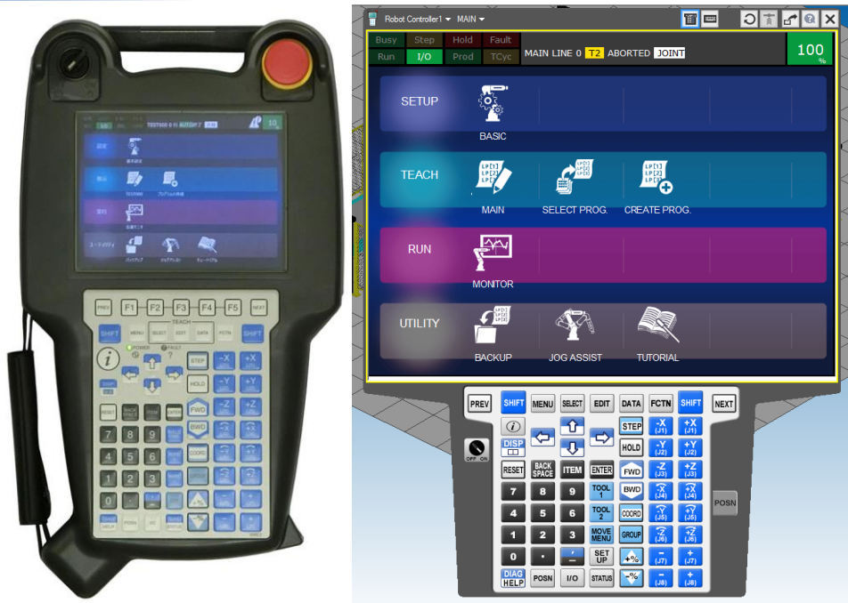
FIGURA 28. Teach Pendant física y de simulación.
