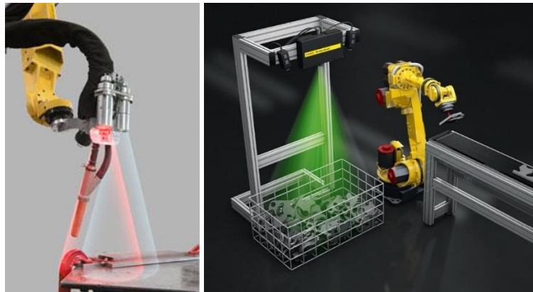
FIGURA 16. Visión Artificial: montada sobre robot y fija.
