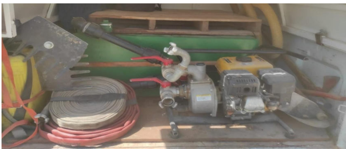
Ilustración 7. Interior de la caja de un vehículo de una cuadrilla de tierra. Podemos observar el depósito verde de 500 litros de capacidad y su motor, además de otras herramientas para la extinción. Fuente propia.
