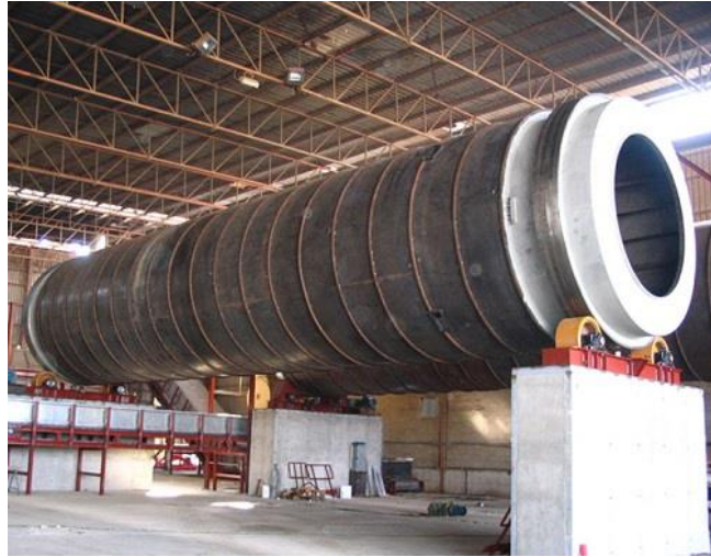
Figura 5: Secadero tipo trommel Fuente: maquinaria eindustria.es
