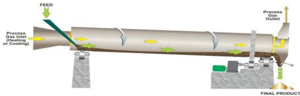
Figura 6: Funcionamiento secadero tipo trommel Fuente: Rudnick and Enners
